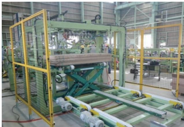
製作した部品を組み付けてお客様の要望に沿った機械創りをしています。(写真は合板自動投入機)
