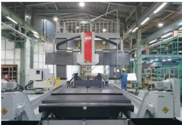
部品製作をする大型の「五面加工機」
